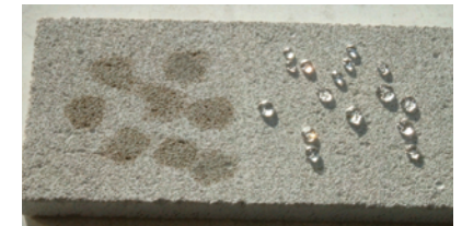
Bild 3 Wassertropfen auf einer Stein-oberfläche, links ohne, rechts mit Isophob-Hydrophobierung
