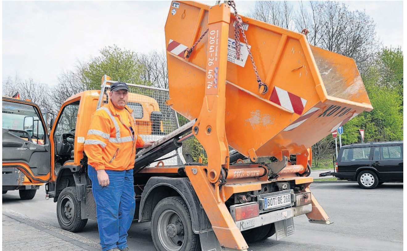
Ein Leichtgewicht unter den Transportern: BEST-Mitarbeiter Michael Vieth bedient den Pfau Rexter, der durch seine kompakte Bauweise äußerst wendig ist und die Minicontainer auch an engen Baustellen oder Hauszufahrten abladen kann. Foto: Franz Naskrent
